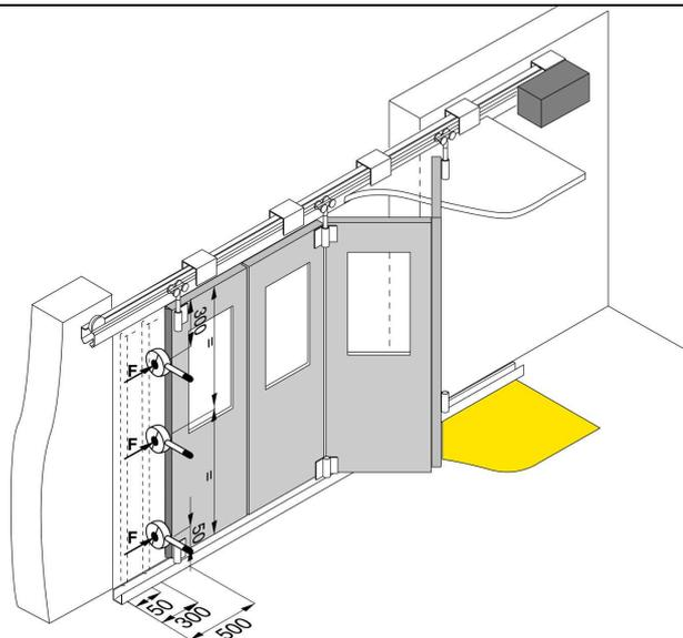
Nel grafico sono indicati i valori massimi delle forze operative dinamiche, statiche e residue, in relazione alle diverse posizioni dell'anta.
