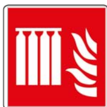
Batteria fissa estintori antincendio
