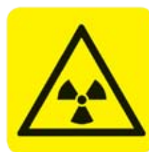
Pericolo materiale radioattivo o radiazioni ionizzanti
