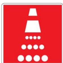
Impianto spegnimento automatico
