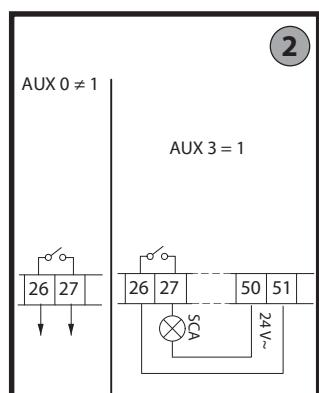
Collegamento di 1 coppia di fotocelle non verificate, per fotocellule verificate vedere pagine seguenti.
