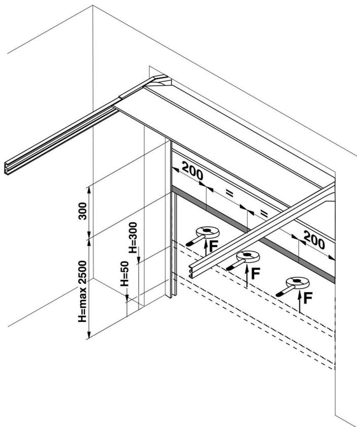
Nel grafico sono indicati i valori massimi delle forze operative dinamiche, statiche e residue, in relazione alle diverse posizioni dell'anta.
